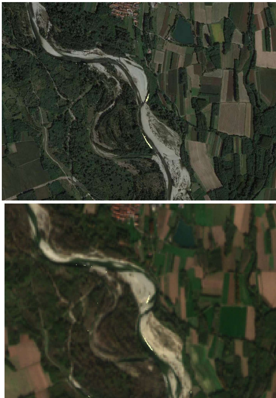
Figura 7.5: Previsione di aree di erosione su ortofoto del 2019 (sopra) e su immagine satellitare recente (sotto).
