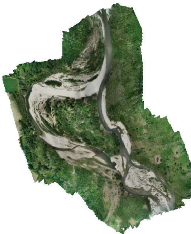
Figura 4.1: Ortofoto del rilievo effettuato in Maggio 2020, nei pressi del salto di meandro avvenuto in località San Benigno
